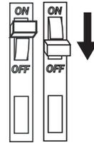
**1** Scollegare l'alimentazione elettrica prima di installare la lampada e disegnare i punti di sospensione
