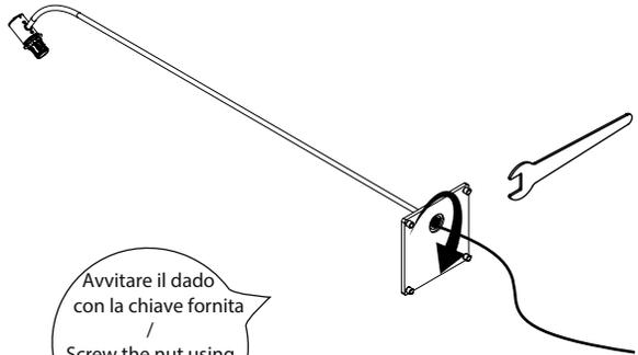
Avvitare il dado con la chiave fornita / Screw the nut using the provided wrench
